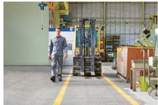
3 Signalisierung des Verkehrswegs und Abgrenzung der Lagerzone
