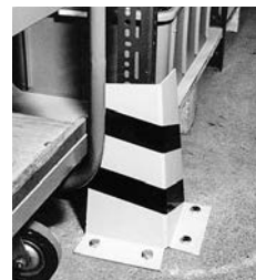
7 Anfahrtschutz an der Ecke eines Regals
